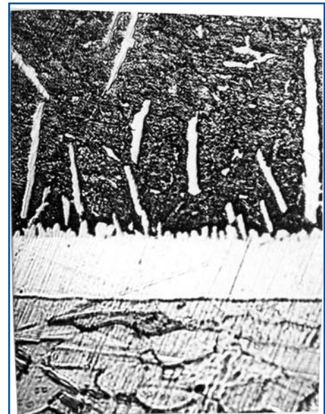
Рис. 9. Паяное соединение по серебряному покрытию (240 °С; 25 с; \times 1000 )
