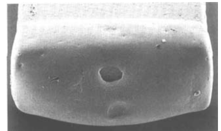
Рис. 19. Удовлетворительная паяемость, контактные поверхности имеют небольшие области, не покрытые припоем
