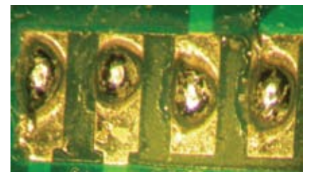
Рис. 9. Неудовлетворительная паяемость контактных площадок, припой не смачивает контактные площадки и собирается в шарики
