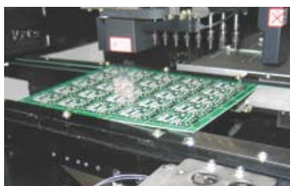
Рис. 2. Дефект печатной платы: деформация по диагонали — скручивание. При движении по конвейеру правый нижний край печатной платы «заехал» на прижимную планку — возможно повреждение оборудования при установке компонентов
