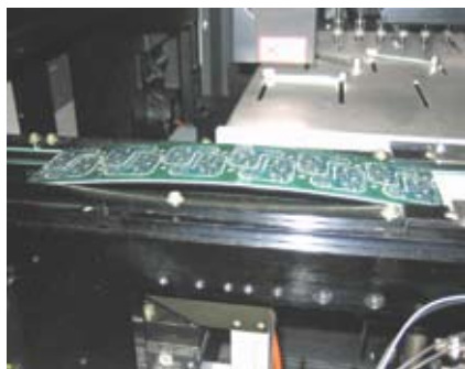
Рис. 1. Дефект печатной платы: продольная деформация — изгиб. Автоматизированная сборка таких плат невозможна
