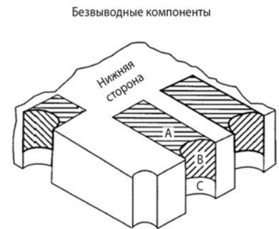
Рис. 16. Критичная зона А (металлизируемая область на нижней стороне компонента) и В (2/3 высоты боковой металлизации компонента)
